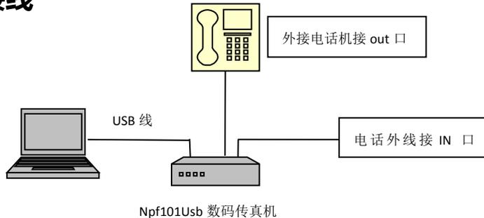
电话进线接 IN 口,OUT 口空着或者接电话机,USB 线一端联接 UFax2 的 USB 口另一端连接电脑主板上的 USB 接口,台式机接机箱后 USB 接口.
