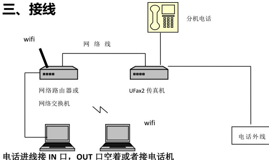
网线一端联接 UFax2 的 LAN 口另一端连接局域网的路由器或者交换机的其中一个网口（参考电脑网线接法）
